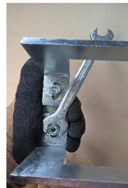
On serre les écrous quand la fermeture a la bonne distance entre les deux côtés
